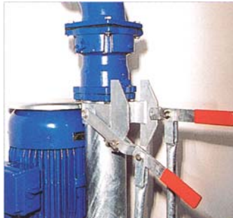
Umstellhebel für Rühren und Fördern
