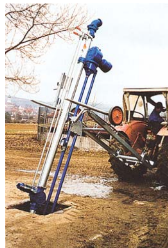
V-Pumpe mit Aushubrahmen und Seilwinde
